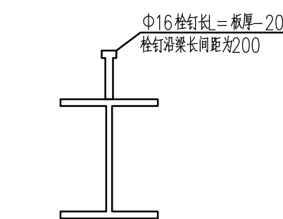
钢梁与栓钉连接大样一 梁宽 < 250
